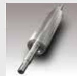
独自の研究開発に基づく特殊製造法にて制作した二重心チルドロールを採用しています。ロールシールの品質は、硬度、及び熱伝導率の平均化ピンホールの皆無等、製品の安全性に優れています。なおシャフトは鍛造品でできており、調質後、研磨仕上げをしています。
